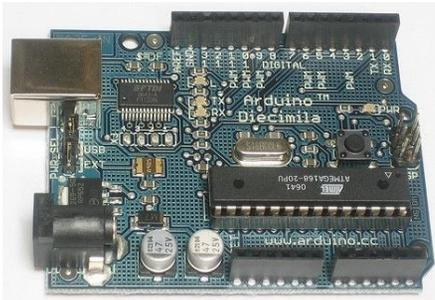
Arduino è una piattaforma di sviluppo open-source e si presenta nelle fattezze di una piccola scheda delle dimensioni di un pacchetto di sigarette. Su di essa sono saldati tutti i componenti che vi servono: il "cervello elettronico" (ovvero un microcontrollore ATmega), i componenti per collegare Arduino al computer (in pratica una porta USB e un convertitore seriale-USB) e le connessioni ver-
