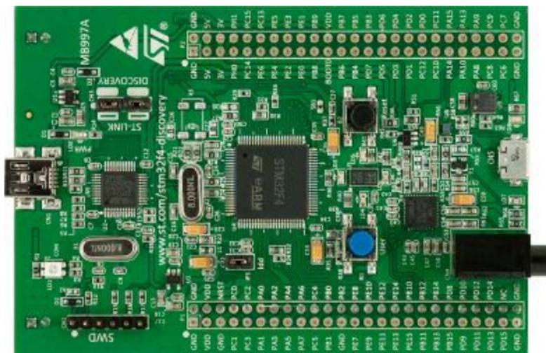
In questo corso useremo una board, la *stm32f4discovery*. Questa board, come Arduino, contiene il microcontrollore e i componenti necessari al suo funzionamento, ed espone i GPIO su due connettori laterali.
