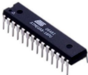
La figura a destra mostra il microcontrollore ATmega328, quello usato nell'Arduino. Come si può notare, ai lati ci sono due file da 14 contatti elettrici, detti “piedini”. Sulla sinistra è evidenziata la funzione di questi piedini.
